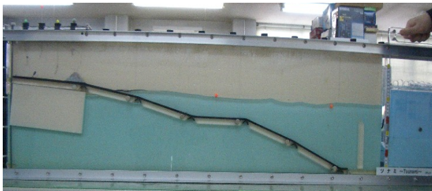
① 模型右端の造波シリンダーを押し下げると、液体がシリンダー下部から横に押し出されます。
