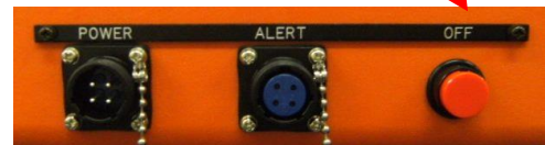
電源ケーブル 警報装置 警報装置 接続口 接続口 停止ボタン
