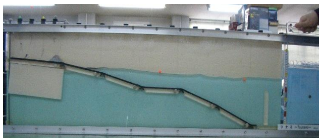
① 模型右端の造波シリンダーを押し下げると、液体がシリンダー下部から横に押し出されます。
